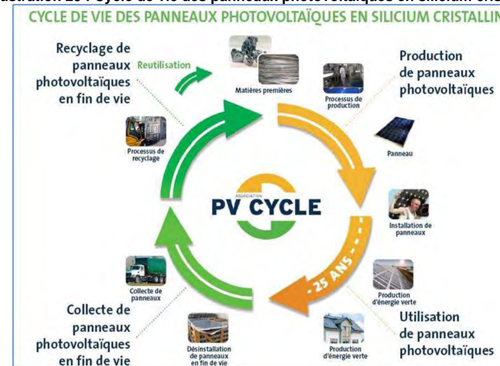
Illustration 23 : Cycle de vie des panneaux photovoltaïques en silicium cristallin
