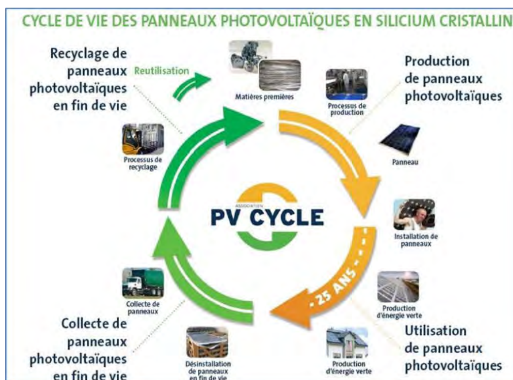
Cycle de vie des panneaux photovoltaïques en silicium cristallin
